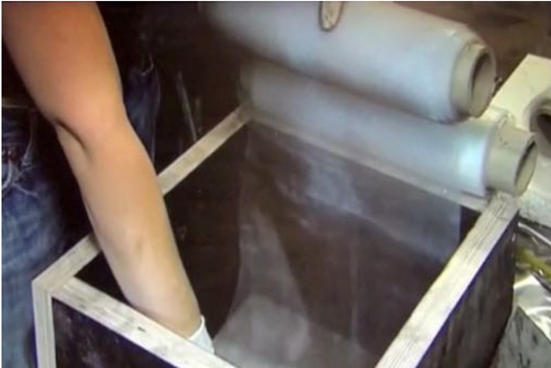
Werdegang eines Lichtsteins mittels Einlegen der Lichtleiterbahnen – Schicht für Schicht - ...
